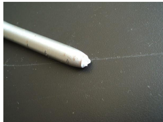
延性断裂后的断口形貌
